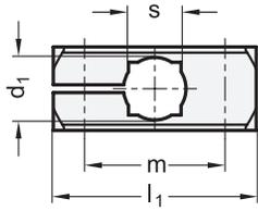
Senkung für Zylinderschraube DIN 912
