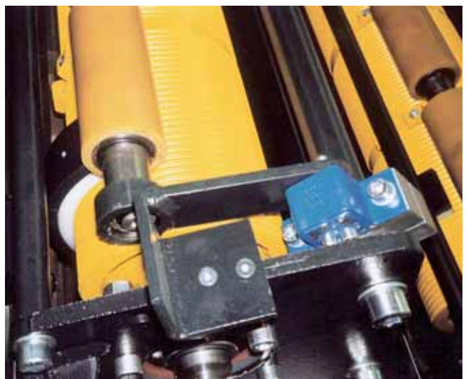
Tastrollenlagerung in Wellpappe-Maschine
