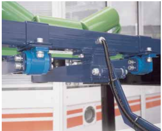
Lagerung Wägeinheit an Förderband
