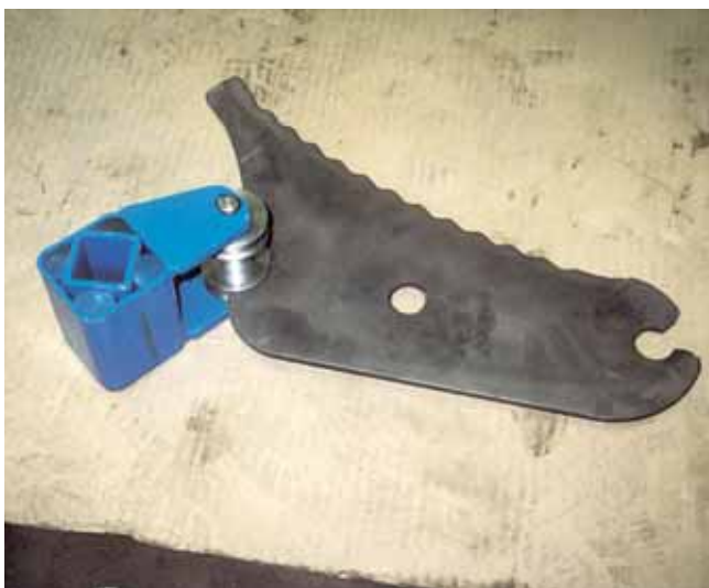
Formmesserlagerung zu Ballenpresse
