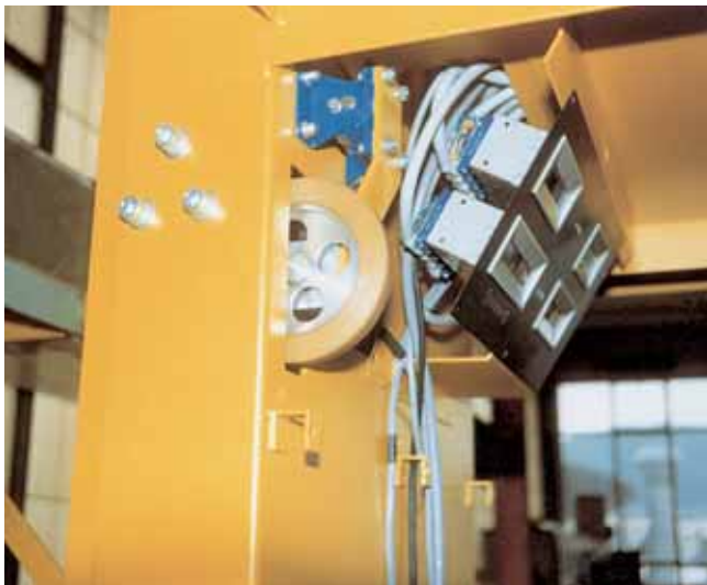
Tastrollenlagerung in Aufzug
