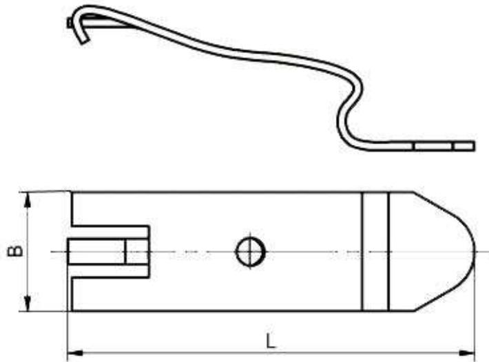
**Befestigungssatz (Schiene) für Grundejektoren**
